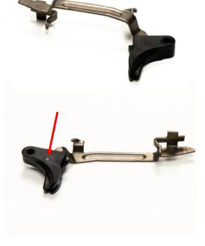
5. LOCATE THE NEWLY CREATED DIMPLE ON THE RIGHT SIDE. TAKE YOUR PUNCH TOOL AND STRIKE THE DIMPLE ON THE RIGHT SIDE TO EJECT THE PIN.
