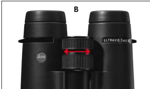
Con uno de los dos anillos se ajusta nítida mente entonces el tubo respectivo en relación a un objeto. A continuación se ajusta en el otro anillo el segundo tubo a la nitidez óptima. El orden se puede elegir de forma arbitraria. Presionando hacia abajo el anillo de graduación dióptrica se memoriza entonces el valor ajustado. El valor respectivamente ajustado se puede leer cómodamente en la escala precisa.
